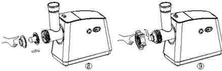
Разберите мясорубку, выполнив шаги 5-3 из подраздела «Сборка» (до съема решетки и ножа). Наденьте насадку для кеббе на посадочное место камеры, как показано на рисунке 8. Убедитесь, что выступы на насадке совпадают с пазами камеры. Плотно закрутите прижимную гайку (Рис. 9). Не перекручивайте гайку.
