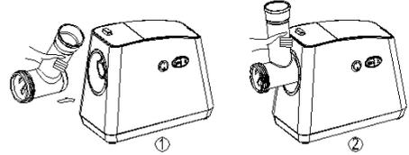
1. Возьмите камеру мясорубки и вставьте ее как показано на Рис. 1 в отверстие для установки. Затем поверните камеру мясорубки против часовой стрелки, чтобы зафиксировать (Рис. 2). Слегка покачайте камеру мясорубки, чтобы убедиться, что она надежно держится.
