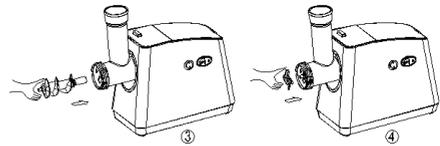
2. Вставьте шнек в камеру мясорубки длинным концом внутрь (Рис. 3). Слегка поверните шнек, чтобы зафиксировать его в корпусе мясорубки.
